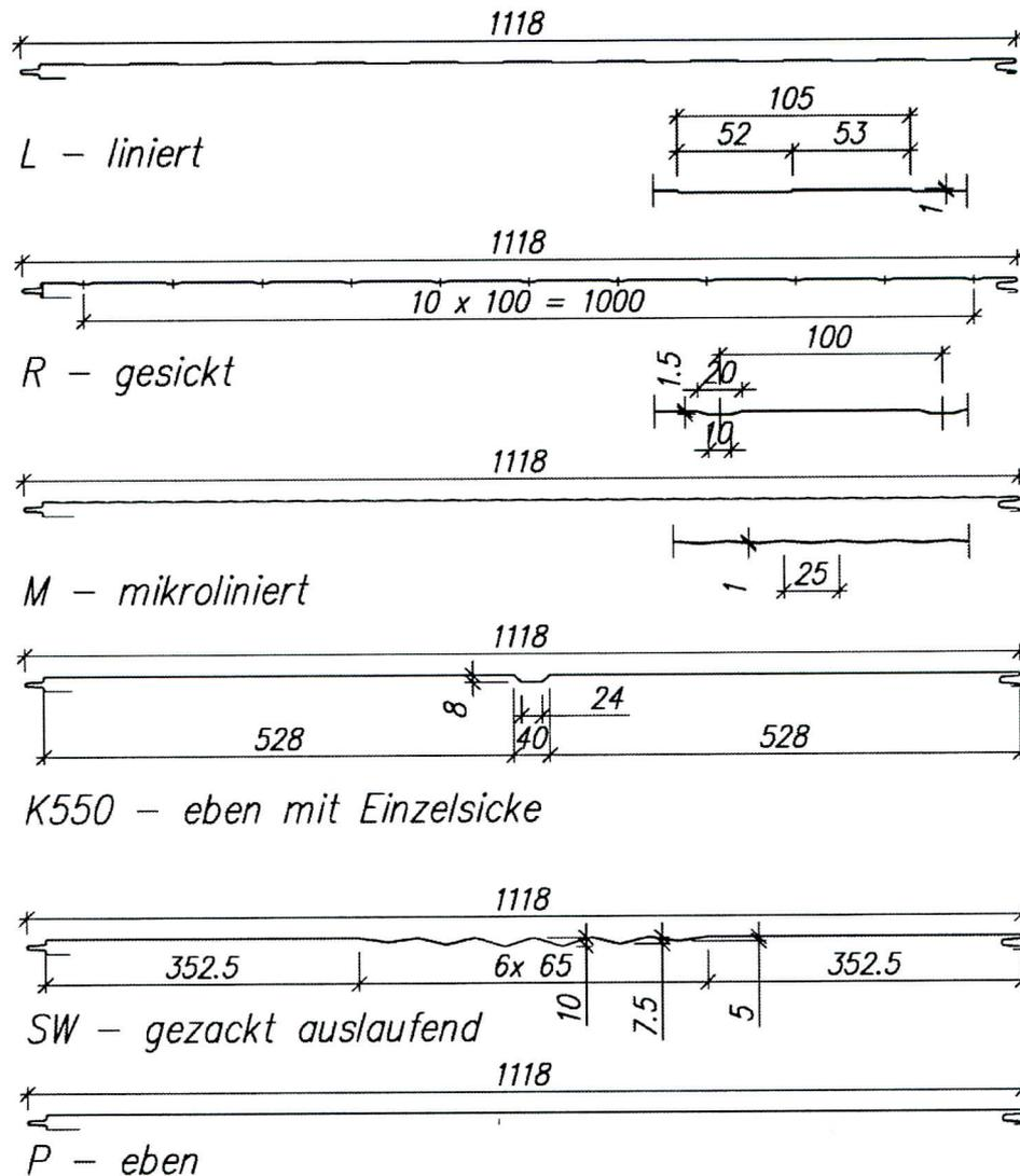
Nennblechdicke der äußeren Deckschicht:  $0,5 \text{ mm} \leq t_{\text{nom}1} \leq 0,75 \text{ mm}$
