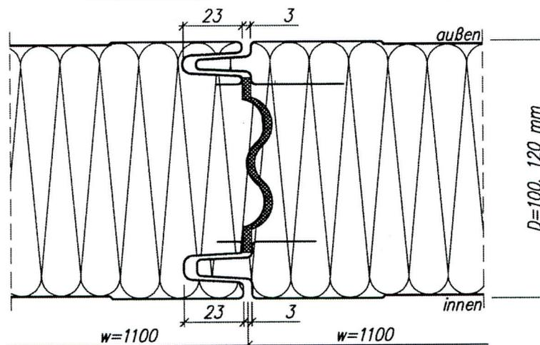
Sandwichelemente "WLOZAMOT Panel" nach EN 14509 mit Stahldeckschichten und einem Kernwerkstoff aus Polyurethan-Hartschaum;
