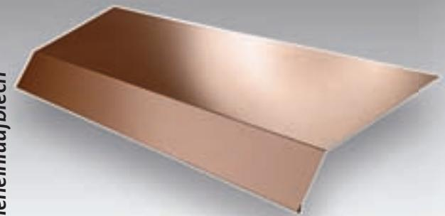
**KEHLRINNE** - zur Ableitung von Wasser aus mehreren aneinander liegenden Dachflächen. Zwecks Abdichtung der Verbindungsstelle zwischen der Kehlrinne und den Pfannenblechen sind universelle, dreieckige, selbstklebende Dichtungen einzusetzen.
