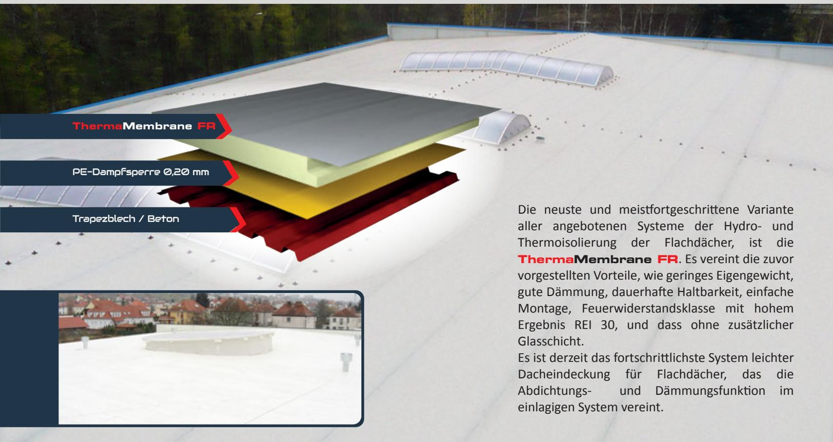
Die neuste und meistfortgeschrittene Variante aller angebotenen Systeme der Hydro- und Thermoisolierung der Flachdächer, ist die **ThermaMembrane FR**. Es vereint die zuvor vorgestellten Vorteile, wie geringes Eigengewicht, gute Dämmung, dauerhafte Haltbarkeit, einfache Montage, Feuerwiderstandsklasse mit hohem Ergebnis REI 30, und dass ohne zusätzlicher Glasschicht.
